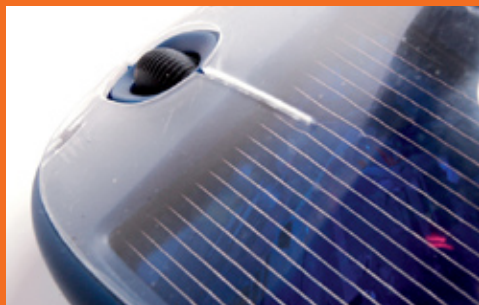
De Sole Mio, prototype van de draadloze muis op zonne-energie.
