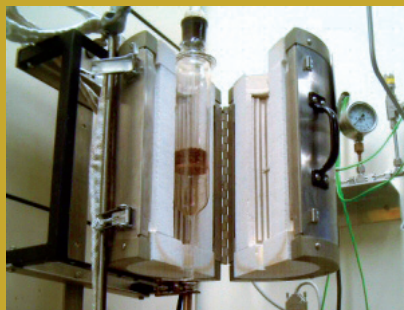
Vergassingsreactor in de proefopstelling in het Eindhovense laboratorium.
